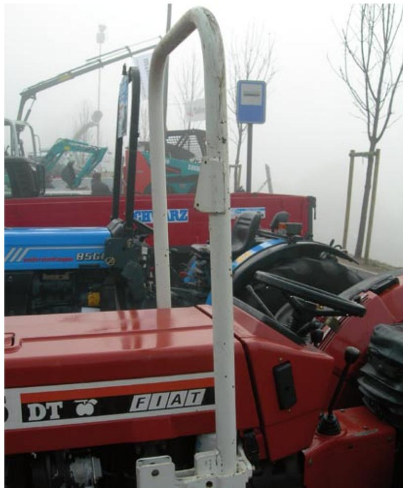
I trattori agricoli sono mezzi facilmente soggetti al ribaltamento perché sono sprovvisti di sospensioni, hanno un baricentro tendenzialmente alto per garantire una luce minima da terra, operano con attrezzature a sbalzo applicate sia anteriormente che posteriormente e sono utilizzati in molti casi in condizioni operative di pendenza del terreno sia trasversali che longitudinali.
