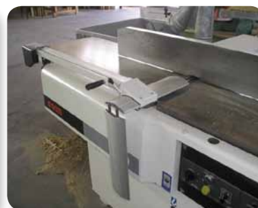
Ponte a regolazione manuale Modello montato su braccio. Esistono anche modelli applicati direttamente in corrispondenza dell'albero pialla
