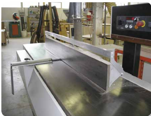
Modello incernierato alla guida, autocostruito: in posizione alta e in posizione di lavoro
