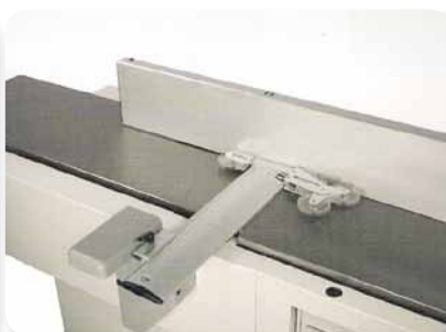
Ponte a regolazione automatica Modello con gruppo ruote ribaltabile all'estremità del ponte; qui è posizionato in orizzontale per la piallatura sul filo
