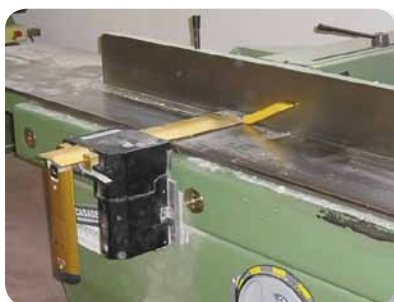
Ponte a regolazione automatica Modello con becchetto infilapezzo ribaltabile all'estremità del ponte; qui è posizionato in verticale per la piallatura sul piano
