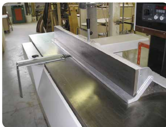
Modello incernierato alla guida, autocostruito: in posizione alta e in posizione di lavoro
