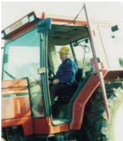
Fig. 33 - L'apertura di una cabina insonorizzata comporta un innalzamento del rumore all'orecchio del conducente che può raggiungere anche i 10 ÷ 15 dB(A).
