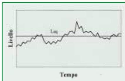
Fig. 11 - Se il livello della pressione acustica - come spesso accade - è di entità variabile nel tempo, il suo valore "medio" è dato dal livello equivalente continuo.
