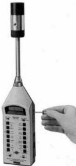
Fig. 27 - Il pistonofono è un piccolo strumento, da applicare sulla capsula microfonica, che genera un segnale acustico di riferimento (ad una data frequenza) grazie al quale si può controllare il corretto funzionamento della catena strumentale (microfono, cavo di prolunga, fonometro) (Brüel & Kjær, '90).
