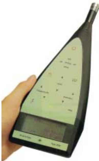
Fig. 25 - Fonometro digitale integratore dell'ultima generazione, concepito per rispondere alle esigenze di rilievo poste dal D.Lgs. 277/91 (Brüel & Kjær, '93).
