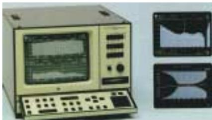
Fig. 28 - Nelle ricerche in cui si vuole conoscere la composizione spettrale del rumore si può ricorrere ad un analizzatore in bande d'ottava o di frazioni d'ottava (Brüel & Kjør, '93).
