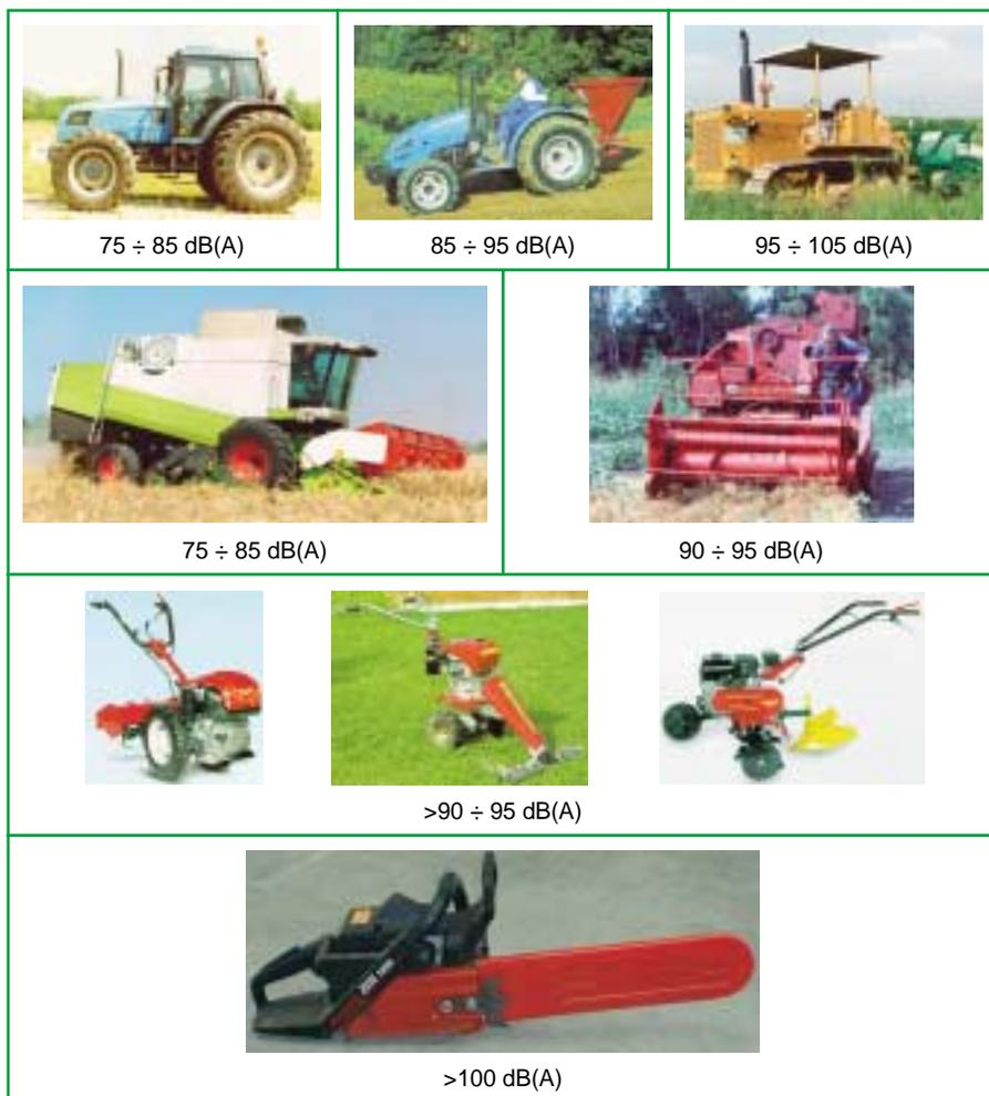
Fig. 32 - Valori indicativi del livello di rumore ( $L_{Aeq}$ ) cui è esposto l'utilizzatore di alcune rappresentative macchine agricole.
