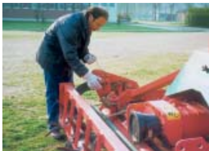
Fig. 10 - Regolazione della profondità di lavoro da terra tramite la registrazione del rullo.
