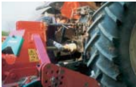
Fig. 6 - Collegamento dell'albero cardanico alla trattrice; l'albero cardanico deve essere fissato correttamente alla p.d.p. e al lato macchina rispettando il verso di rotazione e fissando i dispositivi di ritegno (catenelle) per evitare la rotazione delle protezioni.
