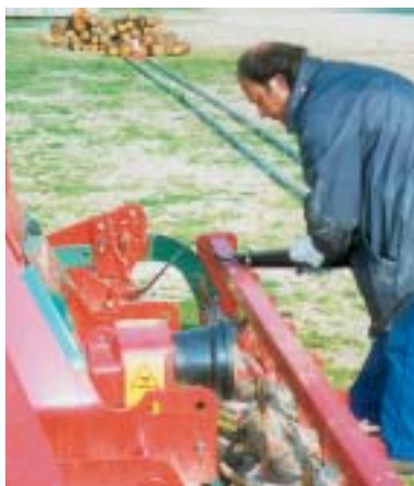
Fig. 21 - Le operazioni di manutenzione includono, oltre all'eliminazione dei residui di vegetazione e la sostituzione degli utensili, l'ingrassaggio di parti mobili.
