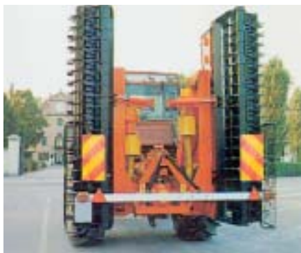
Fig. 19 - Erpice rotativo con elementi ribaltabili, in posizione di trasporto, munito di protezioni laterali amovibili e di pannelli posteriori per la segnalazione degli ingombri laterali.
