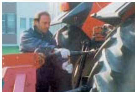
Fig. 4 - Regolazione del terzo punto del sollevatore per evitare oscillazioni della macchina durante il trasporto e il lavoro.
