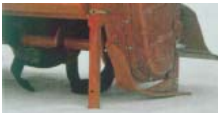
Fig. 5 - Piede di appoggio per evitare il ribaltamento accidentale.
