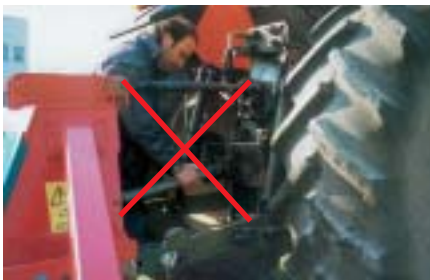
Fig. 7 - L'albero cardanico deve essere dotato di protezioni idonee per tutta la lunghezza dell'albero e dei giunti cardanici sia sull'operatrice che sulla trattrice.
