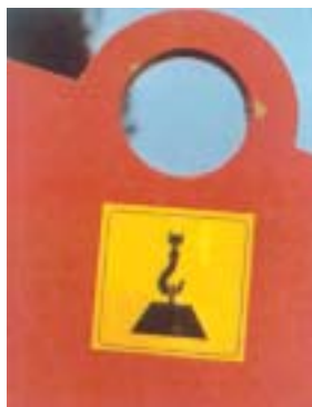
Fig. 20 - Occhione per consentire la movimentazione della macchina con relativo pittogramma di identificazione.
