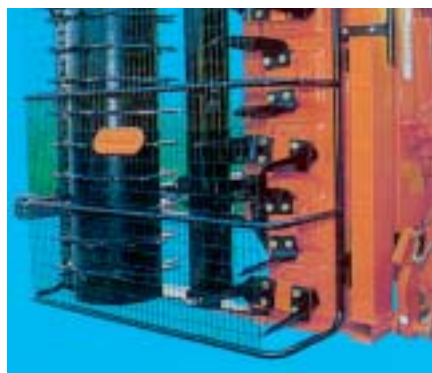
Fig. 18 - Erpice rotativo con elementi ribaltabili, in posizione di trasporto, munito di protezioni amovibili (l'altezza minima della protezione deve essere almeno di 270 mm dalla base della macchina e, comunque, non oltre l'altezza della macchina stessa).
