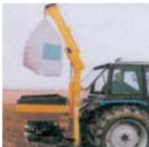
Fig. 7 - Carico della tramoggia mediante apparecchiatura di sollevamento.
