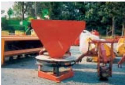
Fig. 1 - Spandiconcime con distributore a reazione centrifuga di tipo portato.
