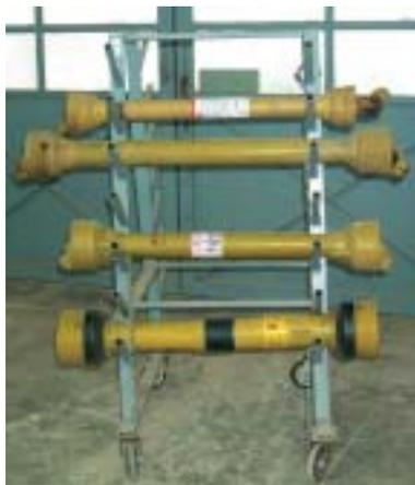
Fig. 10 - Esempio di rastrelliera per riporre dopo l'uso gli alberi cardanici.
