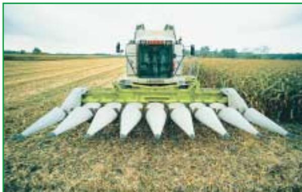
Fig. 19 - Mietitrebbiatrice con testata per la raccolta del mais.
