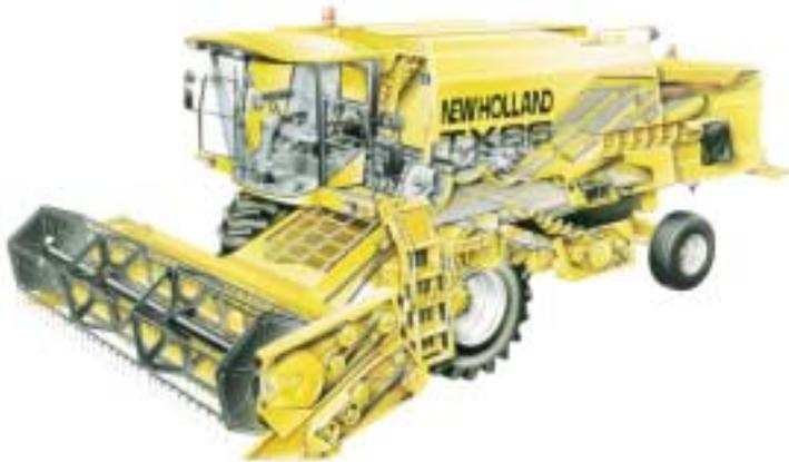
Fig. 2 - Spaccato di mietitrebbiatrice semovente con barra frontale e gruppo battitore trasversale.
