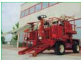
Fig. 5 - Agevolatrice dotata di nastri trasportatori per il convogliamento dei frutti.
