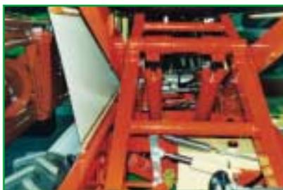
Fig. 3 - Cinematismo a pantografo per l'elevazione delle piattaforme elevabili.
