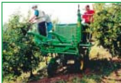
Fig. 4 - Carri agevolatori dotati di dispositivi di autolivellamento per il mantenimento orizzontale del piano di raccolta, adatti per la raccolta in zone collinari.
