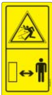
Fig. 10 - PERICOLO di lancio di materiale dalla macchina – Rimanere a distanza di sicurezza (indicata nel manuale di istruzioni).
