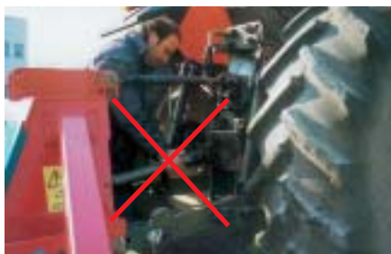
Fig. 5b - L'albero cardanico deve essere dotato di protezioni idonee per tutta la lunghezza dell'albero e dei giunti cardanici sia sull'operatrice che sulla trattrice.
