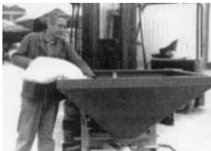
Fig. 12 - Carico della tramoggia manuale (per la movimentazione dei carichi vedere DLgs 626/94).
