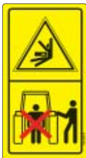
Fig. 17 - Pittogramma indicante il divieto di sostare fra la trattrice e l'operatrice.
