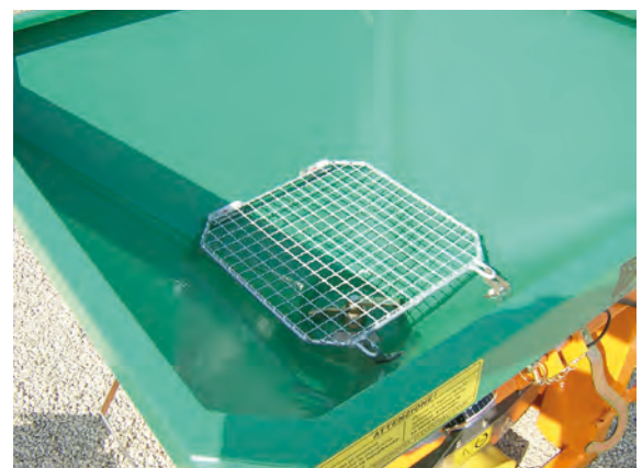
Griglia mobile nella tramoggia
