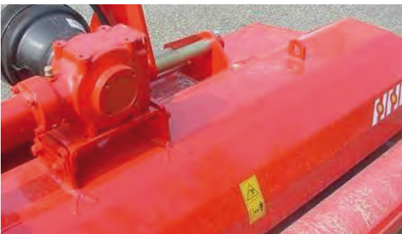
Esempi di protezione superiore in lamiera
